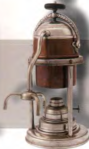
Esempi di "Pressione di vapore" con riversamento direttamente in tazza
